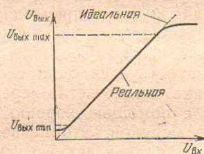
Рис. 4.4. Амплитудная характеристика усилителя
